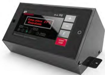
Новая прогрессивная модель контроллера SP-32 PID позволяет сделать простой твердотопливный котёл котлом длительного горения и значительно увеличить эффективность сгорания топлива (дрова, уголь, торф и отходы деревообработки), управляет нагнетательным вентилятором котла, насосом ГВС и насосом отопления имеет сенсорную панель, возможность подключения комнатного термостата, а так же датчик температуры выходящих газов.
