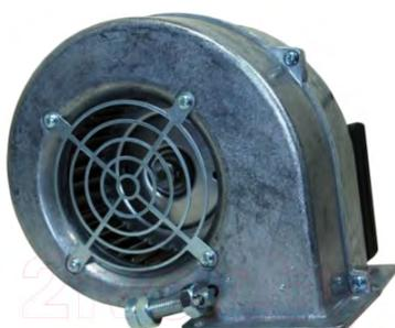
Вентилятор предназначен для наддува воздуха в топку котла или печи мощностью до 40–80 кВт или котла с угольной горелкой мощностью 75–100 кВт. Может также применяться для вентиляции помещений и технологических устройств.
