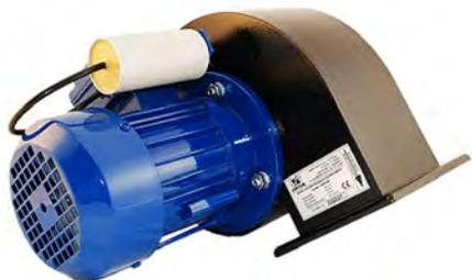
Вентилятор для котла HORNET 105 предназначен для использования в твердотопливных котлах большой мощности, выполняет принудительную подачу воздуха в камеру сгорания, при этом обеспечивает 100% сжигание топлива, соответственно увеличивает КПД котла.
