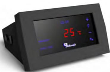
Устанавливается как опция в котлах. Контроллер KGElektronik CS-19 с сенсорной панелью - управляет нагнетательным вентилятором котла, насосом ГВС и насосом отопления имеет сенсорную панель и возможность подключения комнатного термостата. CS-19 представляет собой интеллектуальный контроллер для управления процессом горения древесины, угля и торфа.
