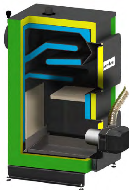
Разрез котла W Pellet
