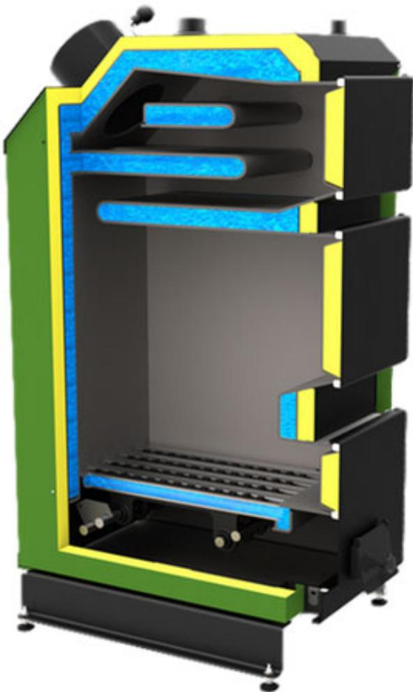
Котлы PREMIUM имеют проверенную конструкцию с почти тройным горизонтальным преломлением газов. Преимуществом котла является большая камера сгорания, длительность работы на одной загрузке, простота и долговечность конструкции, возможность использовать в энергонезависимой системе.
