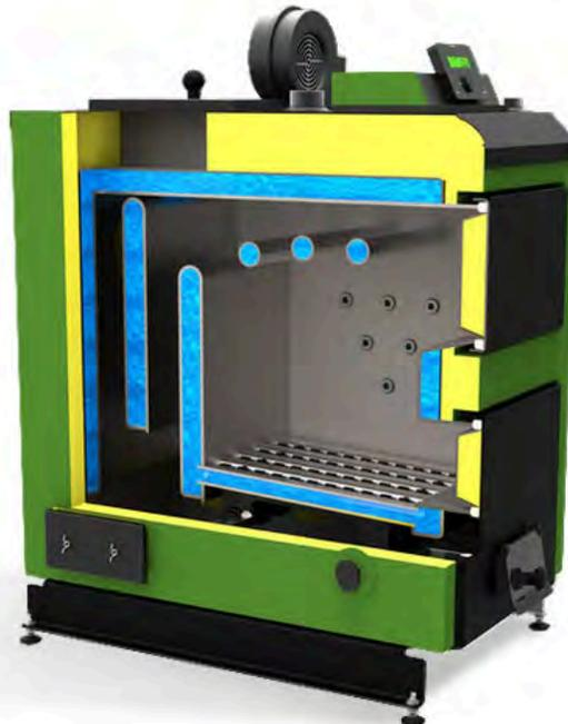
**Камера сгорания оснащена решеткой с «водным» охлаждением**, изготовленной из изогнутой котельной трубы с толщиной стенки 7 мм и воздушными каналами позволяющими подавать воздух для верхнего горения засыпного топлива.
