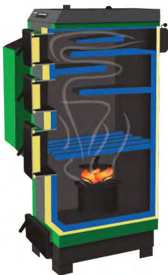
Рис 2. Разрез котла MULTIplus
