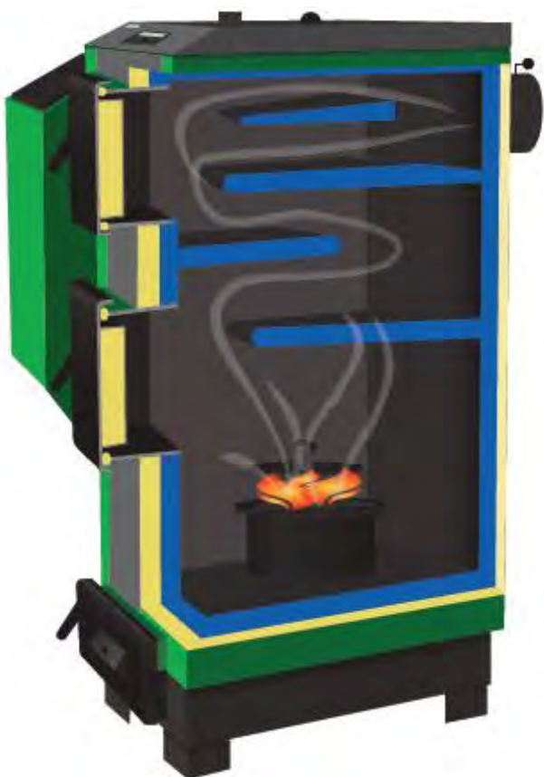
Рис 1. Разрез котла MULTI
