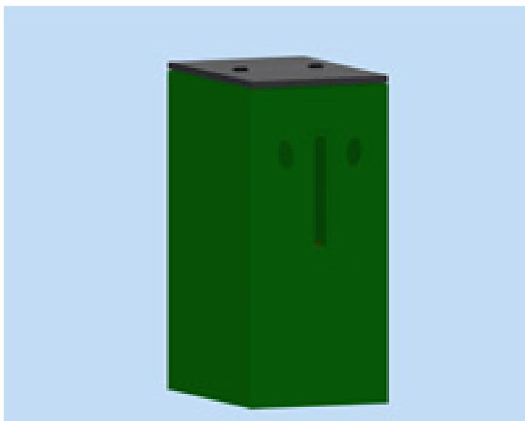
Ёмкость для топлива изготовлена из стали и окрашена порошковой краской в цвет котла. Лоток выхода подающего устройства расположен в ёмкости, что надёжно крепит его.
